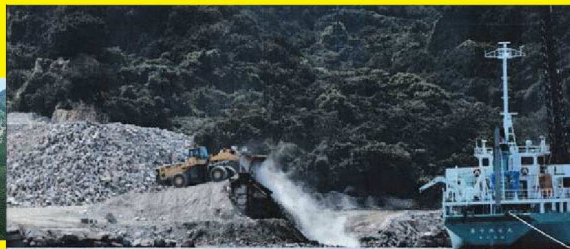
香川県 小豆島当浜地区 砕石を海水で洗浄し運搬船に積み込む(2016.8.27撮影)
